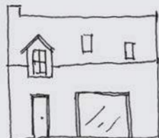
Grandes ouvertures doivent plutôt être positionnées à l'arrière du bâti, rythme des ouvertures de toit nuit à la lisibilité de la façade
